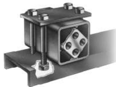
Fig8 槽钢夹具安装
