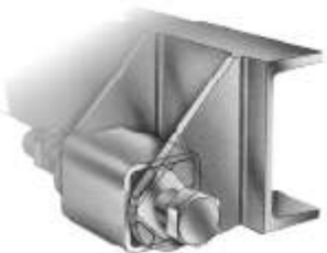
Fig19 通过内方预置的过孔
