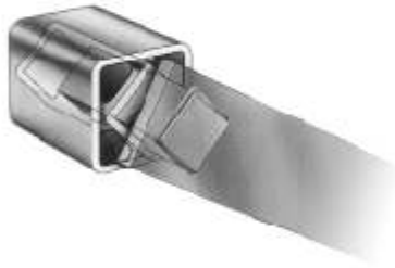
Fig13 力臂焊接在方形块上，插入式连接方式
